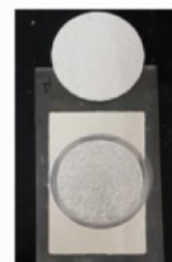
Figura 10 – Ruptura interface substrato/textura
