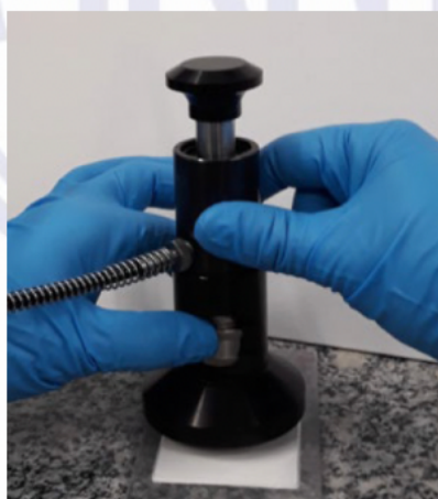
Figura 7 – Encaixe do equipamento abrindo o engate inferior para encaixe na pastilha dolly
