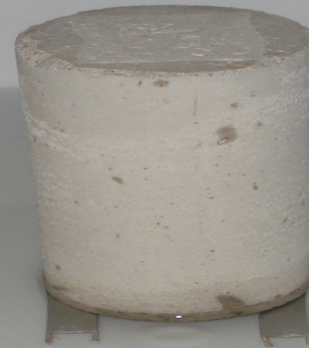
ARGAMASSA COM IMPERMEABILIZANTE
